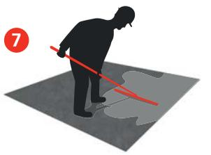
Extender el producto de forma superficial usando llanas de goma, o mecánicamente con el equipo apropiado.
