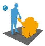
Compactación mecánica, sin vibración, hasta conseguir la densidad de proyecto. Un rodillo lanza de hasta 1.000 kg es un método adecuado.
