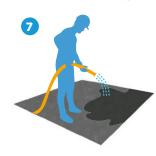
En cuanto finalice el proceso de compactación, se cubrírá con una lámina de plástico para mantener la humedad, sobre todo de la superficie. Pasadas entre 12 y 24 horas se procederá a realizar un riego pulverizado para mantener dicha humedad, que se repetirá varias veces en función de la desecación, durante las siguientes 24 horas. Ese riego no debe de realizarse de forma que dañe la superficie.
