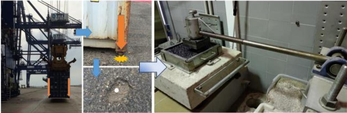
**Figura 13. Esquema del ensayo de resistencia a las cargas por impacto dinámicas.**
