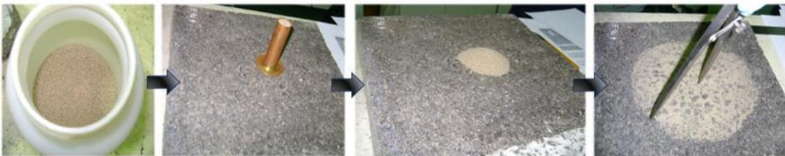
**Figura 7. Esquema de la evaluación de la macrotextura a través del ensayo de círculo de arena.**
