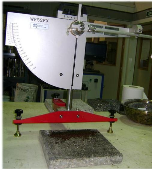
**Figura 6. Péndulo de fricción empleado en la determinación de la resistencia al deslizamiento.**
