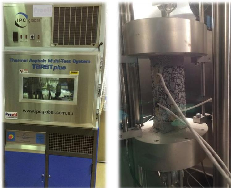
Figura 11. Ensayo TSRST empleado para la evaluación de resistencia a gradientes térmicos.
