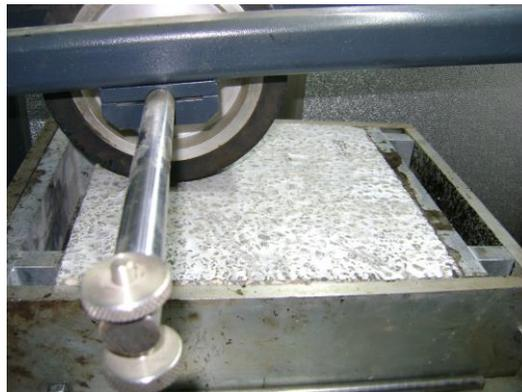
**Figura 14. Ensayo para la evaluación de la resistencia a deformaciones permanentes frente a tráfico lento pesado.**
