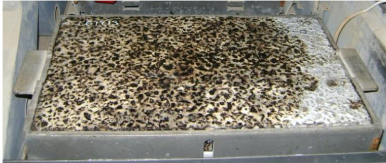
Figura 28. Aspecto de la probeta de pavimento i.tech CARGO tras la acción del combustible.
