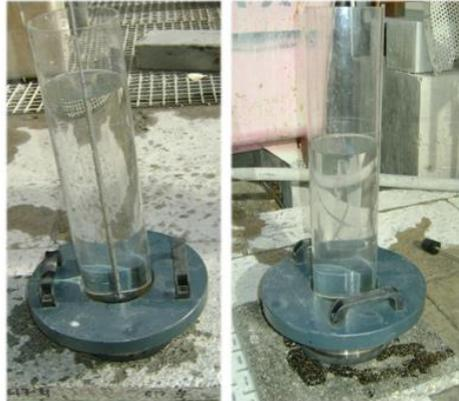
Figura 8. Ensayo de permeabilidad empleado en el estudio.
