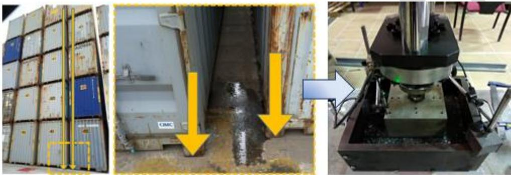
**Figura 12. Ensayo de punzonamiento estático para la evaluación de cargas de almacenamiento.**
